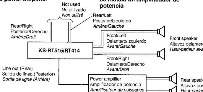
**B. Conexiones de 4 altavoces cuando se instala un amplificador de potencia****B. Raccordements de 4 haut-parleurs en ajoutant un amplificateur de puissance****C. Line Terminal Connections (Line Out)**
