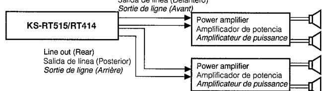
**C. Conexiones del terminal de línea (Salida de línea)**
