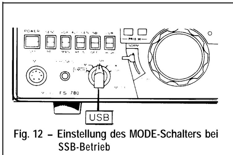
Fig. 12 – Einstellung des MODE-Schalters bei SSB-Betrieb
