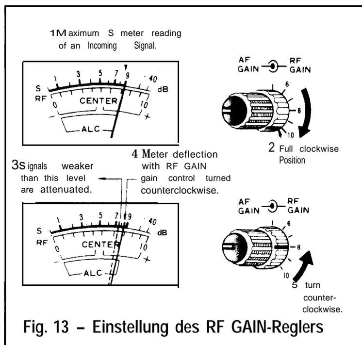
Fig. 13 – Einstellung des RF GAIN-Reglers
