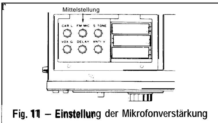
Fig. 11 – Einstellung der Mikrofonverstärkung
