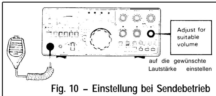
Fig. 10 – Einstellung bei Sendebetrieb
