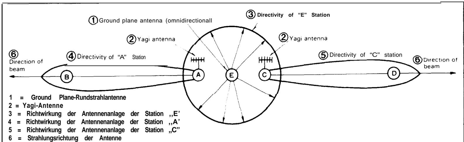
selbst bei Verwendung der gleichen Antennenart bietet die Station „A“ auf dem Hügel bessere Sende- und Empfangsmöglichkeiten als die Station „B“ mit hohem Antennenmast.
